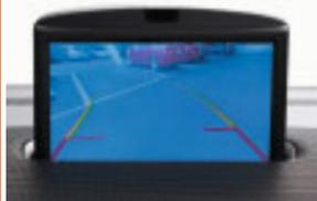
Für den XC90 ist eine Rückfahrkamera erhältlich. Das System gewährt via RTI-Navigationsmonitor einen Weitwinkelaussicht hinter das Fahrzeug, stellt den Rangierbereich verzerrungsfrei dar und unterstützt durch das Einfügen geometrischer Hilfslinien das exakte Einparken.
