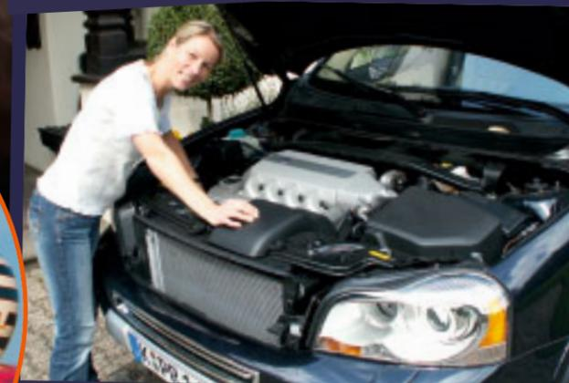
Kompakt, kräftig, leicht: Der erste Achtzylinder-Motor von Volvo leistet 315 PS, ist vollständig aus Leichtmetall und wiegt nur 190 Kilogramm.
